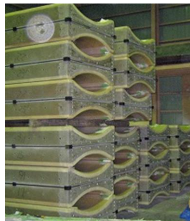
「検査」を待つFRPパネル
